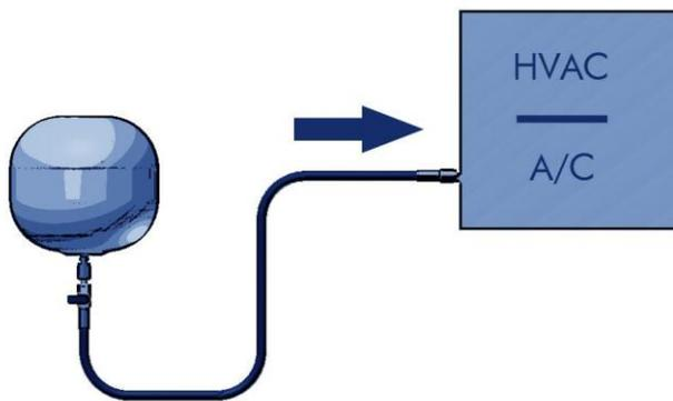
Füllschlauch (Ende ohne Ventil) mit der Klimaanlage verbinden
