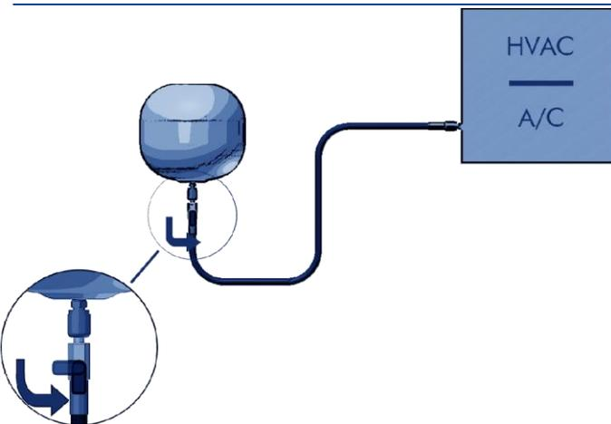
Ventil öffnen, um die Reinigung (SUPER-FLUSH Flüssigkeit) und das Spülen (STICKSTOFF) der Klimaanlage durchzuführen.
