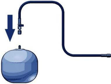
Füllschlauch (Ende mit Ventil) mit der Flasche verbinden
